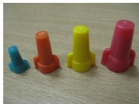
**ЗАЖИМ** – Соединительно - изолирующие зажимы предназначены для соединения и изоляции однопроволочных жил проводов. Зажим выполнен в виде колпачка из полиамида или поликарбоната с запрессованной внутрь металлической пружины конической формы. СИЗ обеспечивает быстрый монтаж/демонтаж проводов без нарушения их целостности, а так же надежную изоляцию соединения. Зажим изготовлен из материала, не поддерживающего горение.
