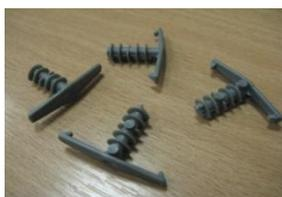
**ЗАКРЕПЫ ТМ2** – Используются для крепления электропроводки к бетонным и кирпичным стенам под штукатурку. Изготавливается из полиэтилена в виде Т-образного дюбель-элемента. Крепеж устанавливается в отверстие диаметром 6-8 мм и обеспечивает надежное крепление.
