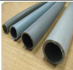
**ТРУБЫ ПНД И ПВД** – Изготавливаются из полиэтилена. Предназначены для предохранения электропроводки от механических повреждений. Используются в электрических сетях напряжением до 1000 вольт. (не используется для водоснабжения)
